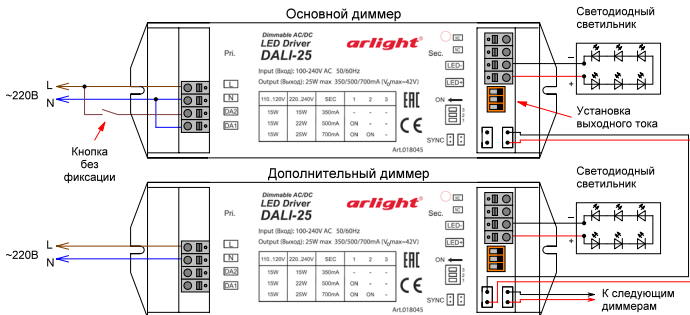
Рис.2. Схема подключения диммеров при использовании управления Touch DIM.
