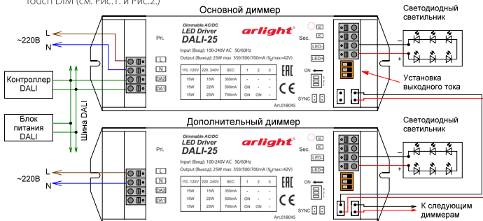
Рис.1. Схема подключения диммеров при использовании управления DALI.
